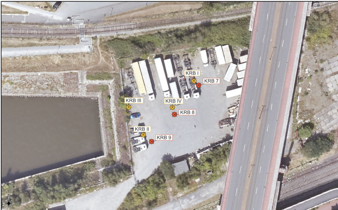
Abbildung 7: Lage der Kleinrammbohrungen KRB 7 bis 9 (2021) und KRB I bis IV (2023), (Quelle: Land NRW (2023), OPEN.NRW.DE, Datenlizenz Deutschland - Zero -, Version 2.0 ( www.govdata.de/dl-de/zero-2-0 ))
