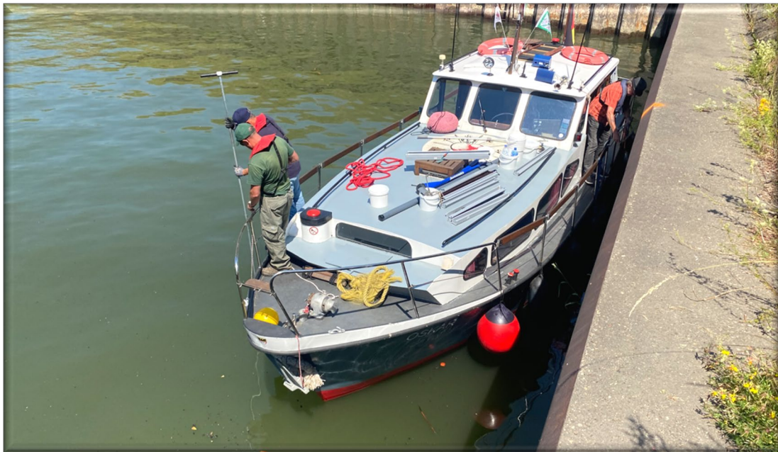
Abbildung 3: Probenahme des Hafenbeckensediments mit Hilfe eines Bootes
