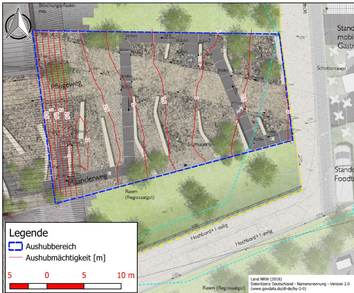
Abbildung 8: Lageplan [6] mit modellhafter Darstellung der Aushubmächtigkeit im Bereich der geplanten Schotterfläche
